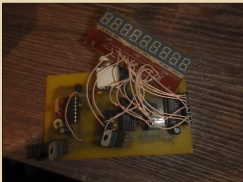
Рис. 7. Собранная плата частотомера
