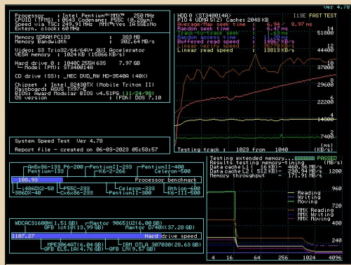
Рис. 5. Результаты тестирования Intel Pentium MMX 166 при шине 83 МГц и множителе 3 (автор решил дальше не рисковать, т.к. прибавка почти 100 МГц к стандартным 166 и так уже даёт ощутимый результат)
