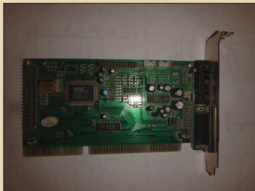
Рис. 5. ESS 1868 – представитель поздних бюджетных звуковых карт на ISA. Собственно, такие автор часто встречал на системниках Slot 1. Разве что у товарища с Duron'ом стояла PCI-ная CMI, но там, возможно, вообще ISA-шины не было
