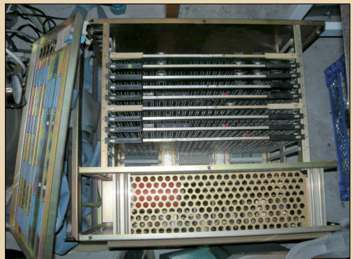
Корзина ND-100 с платами последовательных портов (автор фото – Gandalf, взято с http://www.ndwiki.org )
