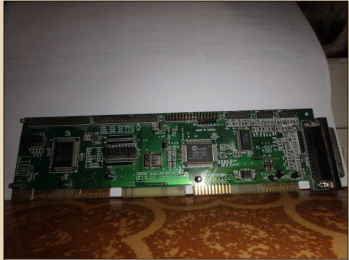
Рис. 9. Только на этой мультикарте удалось запустить мышь, но два IDE-канала для собираемой машины – перебор
