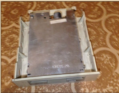
Рис. 4. Дисковод в переходнике – механически он может быть установлен в отсек 5,25", но разъём питания у него как у обычного дисковода (тот дисковод, что достался мне в 2015-м, имел разъём питания как у жёстких дисков и пятидюймовых дисководов)
