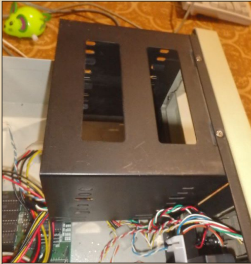
Рис. 3. Отсек для накопителей – в большинстве корпусов есть хотя бы один отсек на 3,5", но здесь такого нет
