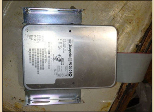
Рис. 5. Жёсткий диск с прикрученными салазками. В таком виде и будет установлен в «пятидюймовый» отсек корпуса
