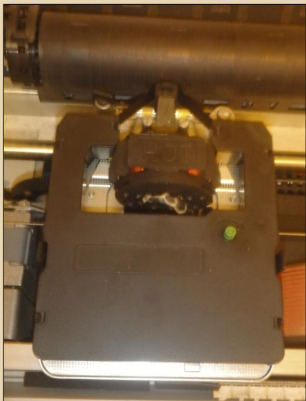
Рис. 2. Картридж для красящей ленты – в отличие от President'a для Commodore C64, картридж, похоже, не менялся, но ленту в нём поменял
