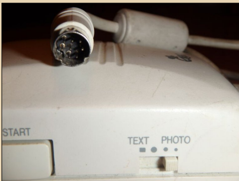
Рис. 7. Разъём для подключения ScanMate/32 к контроллеру – круглый, как у большинства ручных сканеров
