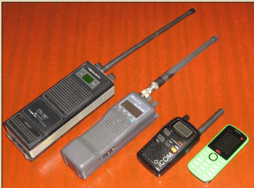
Рис. 2. Носимые «безлицензионные» радиостанции. Слева направо: СиБишки (27 МГц) Tandy Radio Shack TRC-207 и Alan-95; LPD-шка (433 МГц) ICOM IC-4088. Сотовый телефон показан для оценки габаритов радиостанций
