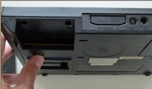
Слот для картриджа и заглушки DB-15 и аудиовхода сверху...
