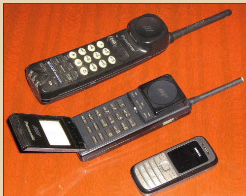
Рис.1. Радиотелефоны. Слева направо: «сортирник» Panasonic KX-TC409, 30 МГц; телефон средней дальности KX-T9050, 900 МГц; кнопочный сотовый телефон Nokia 1208
