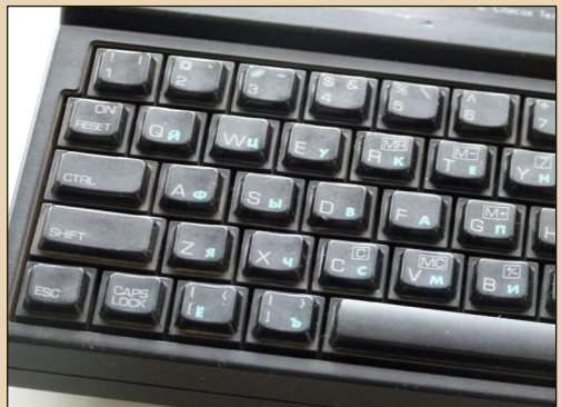
Клавиши не шатаются и нажимаются очень приятно, пусть и жестковаты. А вот место для кнопки ESC было выбрано очень неудачное
