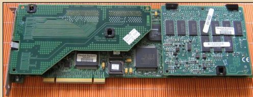
Рис. 24. SCSI RAID Compaq Smart Array 3200 с «дочерними платами»
