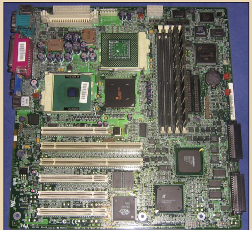
Рис. 16. 2-процессорная серверная материнская плата Intel STL2 со встроенным 2-канальным SCSI-контроллером на чипе Adaptec AIC-7899G
