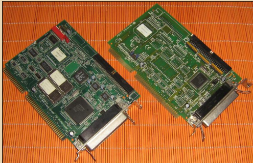
Рис. 12. SCSI-контроллеры фирмы Adaptec для шины ISA ANA-1510A (без BIOS) и ANA-1540CF (с BIOS'ом). Скорость 5 МБ/с
