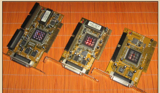
Рис. 14. «Линейка» SCSI-контроллеров фирмы Tekram для шины PCI. Справа налево: DC-315U (без BIOS, Narrow, 20 МБ/с), DC-395U (с BIOS, Narrow, 20 МБ/с), DC-395UW (с BIOS, Narrow+Wide, 40 МБ/с)
