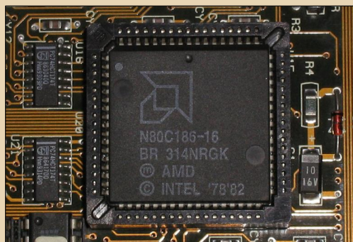
Рис. 18. Микропроцессор RAID-контроллера – аналог i80186
